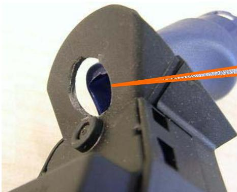
Führen Sie die Kabel vom BC durch den Hebel
