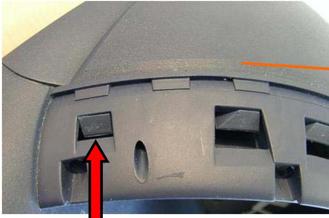
Diese Haken der Reihe nach herunterdrücken und die große Abdeckung nach hinten
