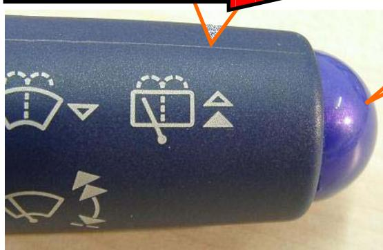
Entfernen Sie die Kappe vom Blinkhebel durch abheben
