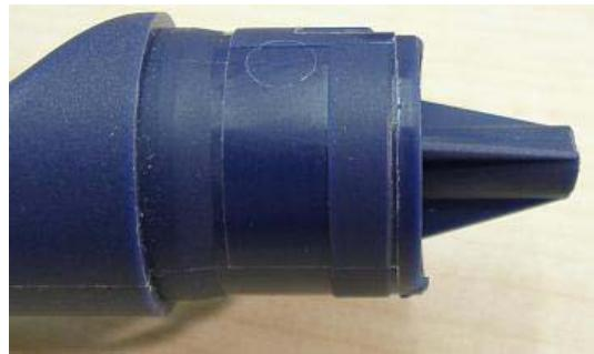
Hier wird ein 5mm Loch zur Kabeldurchführung gebohrt
