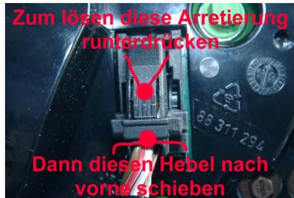
Entnehmen Sie nun das gesamt Tachometergehäuse und beginnen mit der Demontage.
