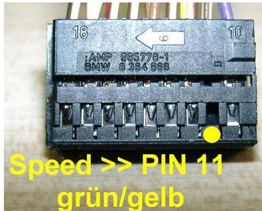
in den freien Kabeleinschub auf **Pin 11** des Fahrzeugseitigen, originalen Tachometerstecker (siehe Montageanweisung wie oben unter „Anschluss Ladedruckkabel“).
