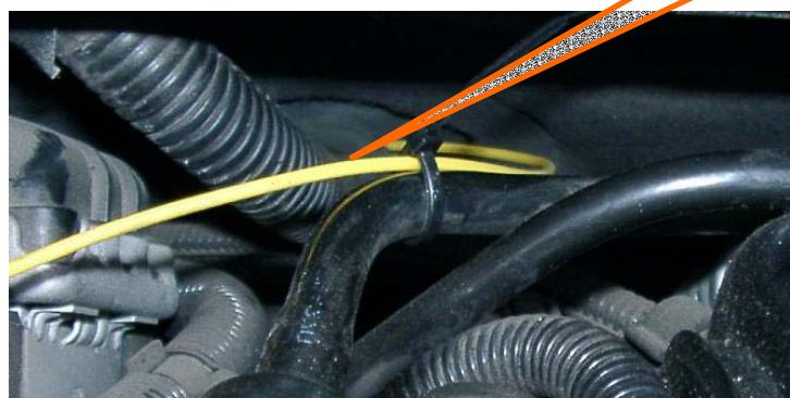
Das Kabel wird nun z.B. mit einem Quetschverbinder an das **grüne** Kabel des Ladedrucksensors
