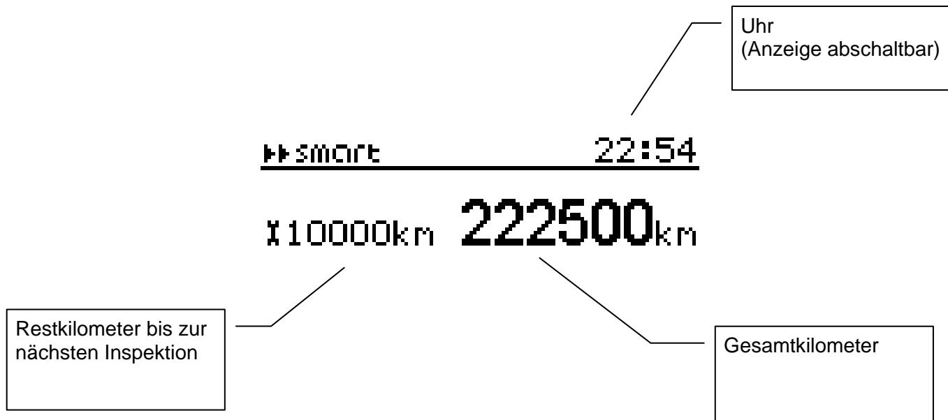
Im Standby Modus wird die Hintergrundbeleuchtung des Display abgeschaltet. Durch Betätigen einer Taste wird die Beleuchtung für 10s aktiviert.
