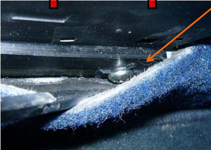
Dann diese Schrauben mit dem Spezial Torx 30 lösen und entfernen
