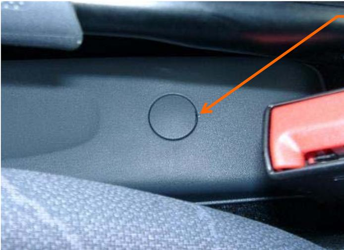
Ziehen Sie den Verschlussstopfen nach oben heraus und entfernen die darunter liegende Torx 20 Schraube.
