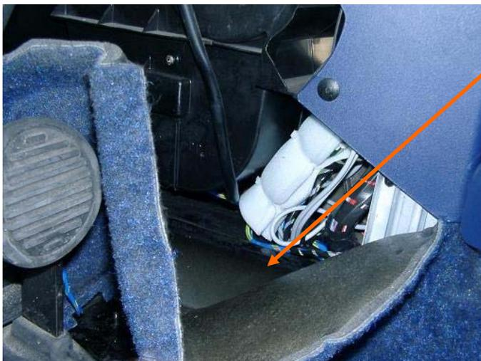
Bei Rechtslenkern hängt das Gaspedal und muss nicht ausgebaut werden
