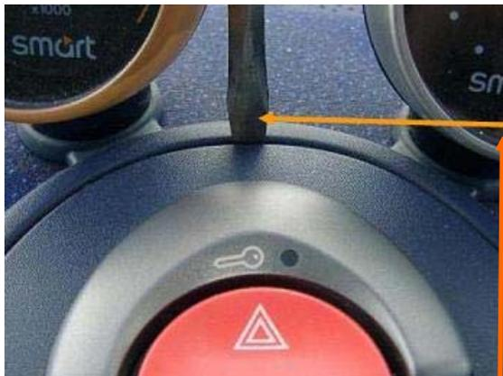
Zum Öffnen der Mittelinsel an dieser Stelle einen Schraubendreher einsetzen und den Deckel der Mittelinsel anheben.
