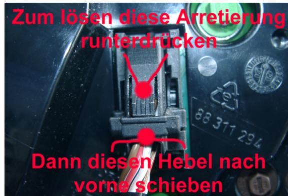
Den originalen Fahrzeugseitigen Tachometerstecker in diese Kupplung einsetzen und verriegeln.
