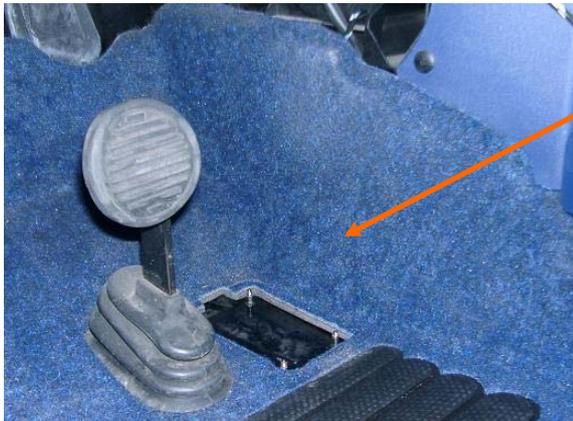
Jetzt das Gaspedal mit seinen 4 M10 Schrauben lösen und den Stecker abziehen.
