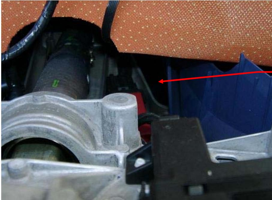
Je nach Bedieneinheit werden nun die grauen Anschlusskabel an der Lenksäule vorbei nach unten zur Steuerplatine geführt. Achten Sie darauf, dass die Kabel nicht an der Lenksäule scheuern. Eventuell mit Kabelbinder sichern
