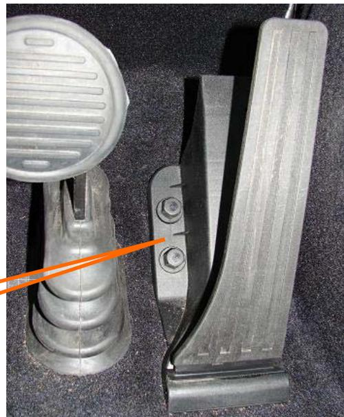
Diese beiden Kunststoffmuttern des Gaspedals entfernen ( 13er Nuss) und das Gaspedal herausheben
