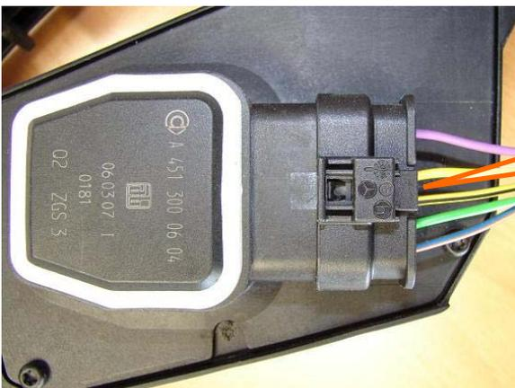
Zum Lösen des Steckers auf diese kleine Lasche drücken und gleichzeitig den Stecker abziehen
