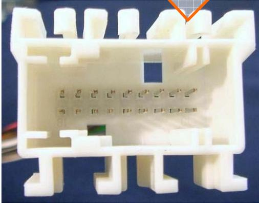
Diesen Stecker in den Tachometer einsetzen und mit dem kleinen Hebel verriegeln.
