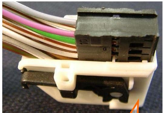
Um unseren Adapterstecker mit dem Anschlusskabel für die Steuerelektronik verwenden zu können muss das Steckergehäuse mit dem originalen, Fahrzeugseitigen Steckergehäuse getauscht werden
