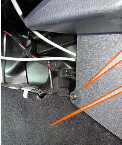
Diese Schraube lösen (Torx 15)
