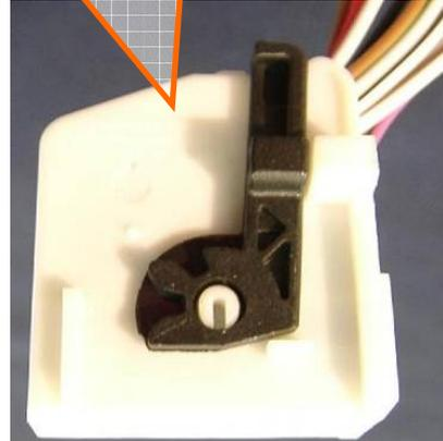
Das Anschlusskabel für die Steuerelektronik in den Fußraum führen. Dabei darf das Kabel nicht an die Lenksäule geraten !
