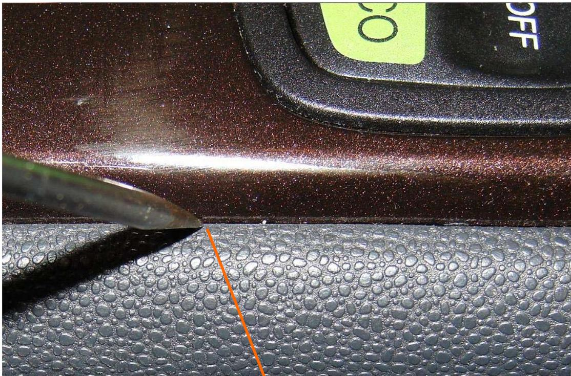
Setzen Sie hier einen kleinen Schraubendreher an um den Schalterraahmen abzuhebeln.
