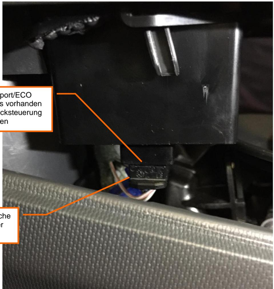
Den Stecker vom Sport/ECO Umschalter lösen. Falls vorhanden den Stecker der Verdecksteuerung ebenfalls lösen
